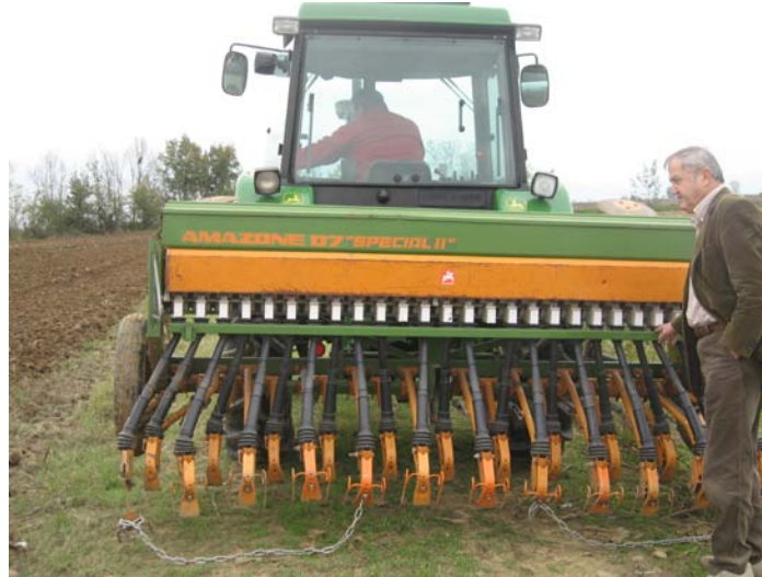
Σχήμα ΠΙ.1 Σπαρτική σιτηρών και μικρών σπόρων που χρησιμοποιήθηκε στη σπορά στα Καλυβάκια.
