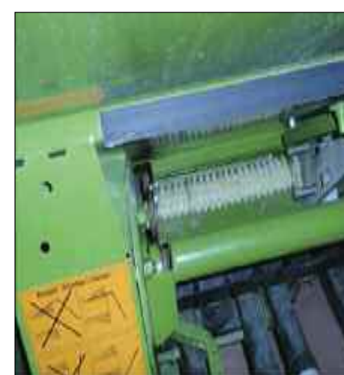
Εικόνα 3. Ιμάντες εξόδου του λιπάσματος σε ένα πνευματικό λιπασματοδιανομέα.
