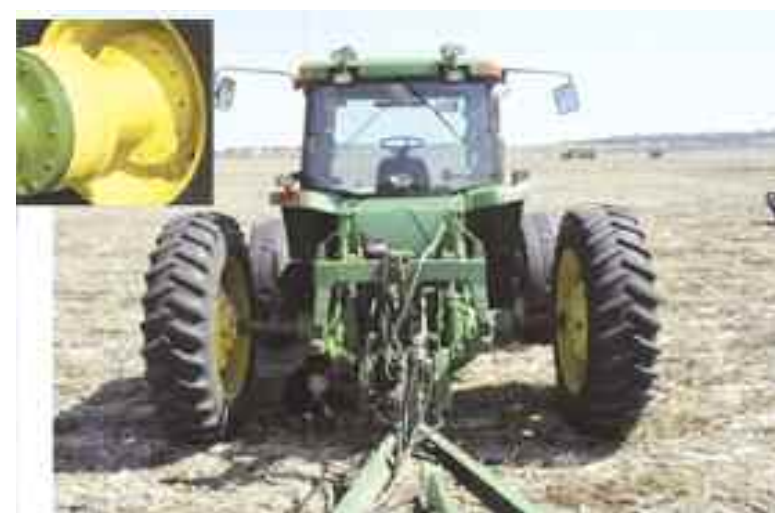
Σχήμα 3. Ελκυστήρας με εύρος τροχών 3 μέτρα με κατάλληλα εξαρτήματα για αύξηση του εύρους
