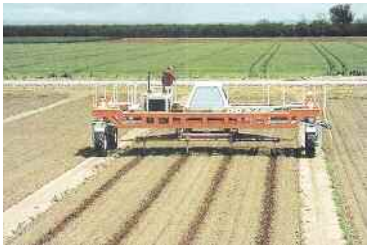
Σχήμα 1. Ελκυστήρας με μεγάλο άνοιγμα τροχών (Gantry)
