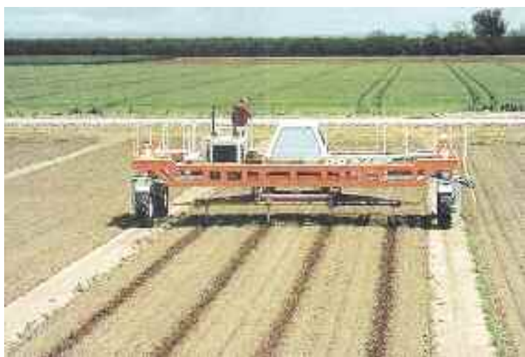
Σχήμα 1. Ελκυστήρας με μεγάλο άνοιγμα τροχών (Gantry)
